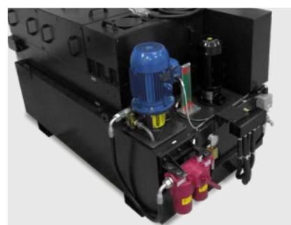
Sistema di filtraggio a carta
